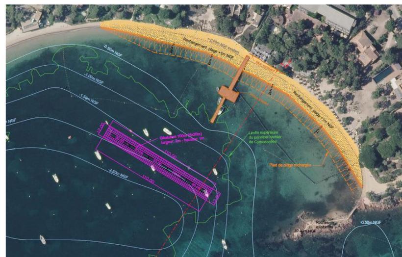
Solution d'aménagement avec rechargement de plage et pose d'une structure tubulaire
