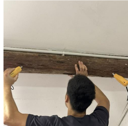
Mesure de la classe de résistance du bois (Sylvatest)
