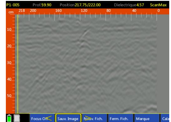
Passage radar au niveau du sol - capture d'écran (détection remblai)
