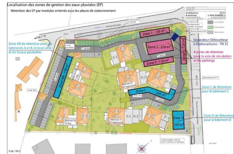
Vue en plan générale du projet de gestion et de traitement des eaux pluviales (ICTP – 2012)
