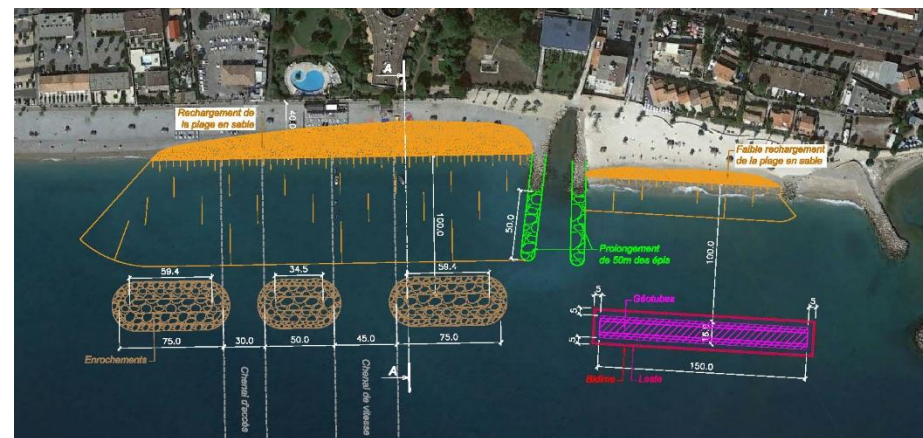
Exemple de solution de protection par rechargement de plage et pose de digues sous-marines (structure tubulaire et/ou enrochements)
