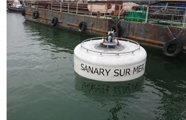
Futur coffre d'amarrage
