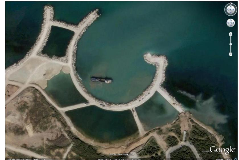
Réalisation terre-plein et ouvrage de protection en enrochements
