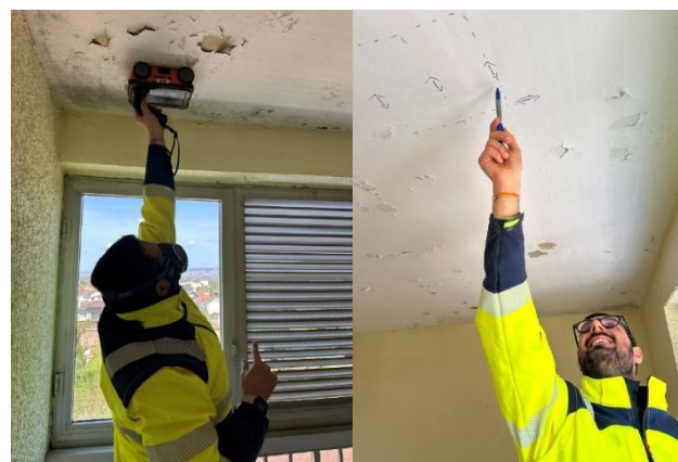
Repérage et détection des armatures (radar) / Mesure de la résistance à la compression (scléromètre)
